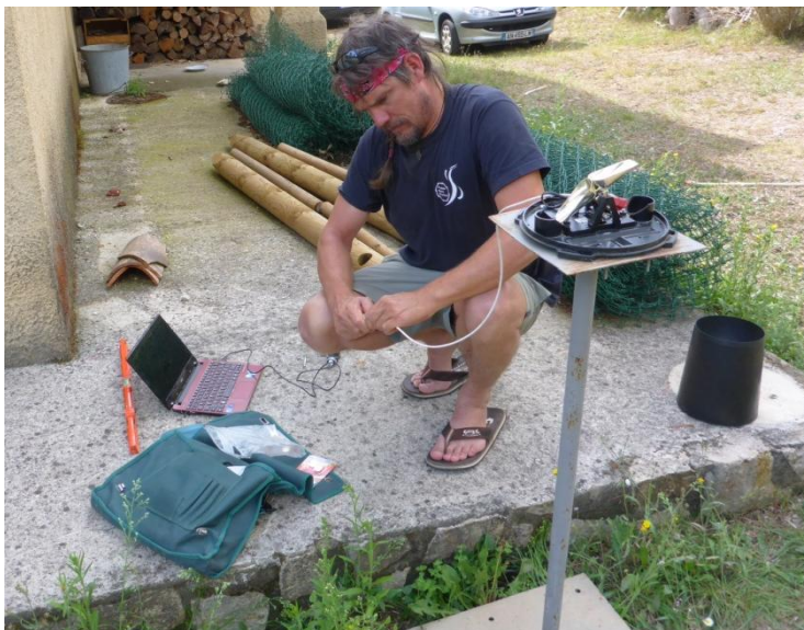
Photo 3 : Pluviomètre à augets, sur son trépied. Le réceptacle est enlevé le temps de connecter l'enregistreur de données à l'ordinateur.
