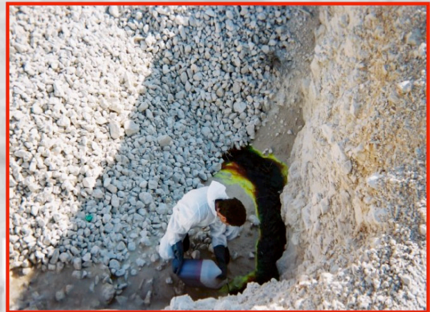
Injection à la fluorescéine (Photo T.L)
